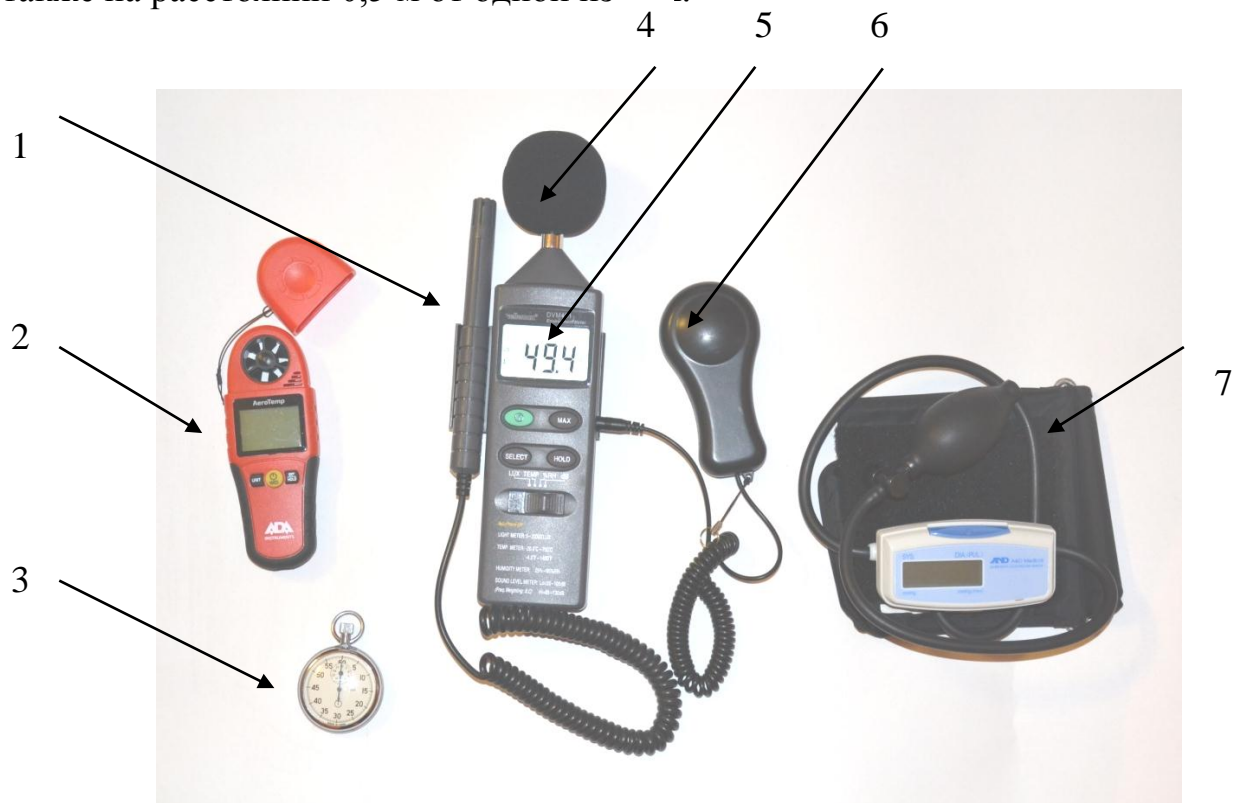
Рисунок 2 - Приборы для контроля параметров условий труда оператора: 1 – датчик для измерения влажности многофункционального тестера окружающей среды DVM 401; 2 - анемометр-термометр AeroTemp; 3 – механический секундомер СОСпр-26-2-000; 4 – микрофон для измерения уровня шума многофункционального тестера окружающей среды DVM 401; 5 - многофункциональный тестер окружающей среды DVM 401; 6 – фото детектор для измерения освещенности многофункционального тестера окружающей среды DVM 401; 7 – полуавтоматический тонометр AND UA-604
